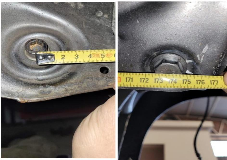
Estructura secundaria y dimensiones, tolerancia +/-5mm.
