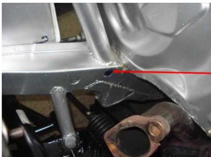
Orificio de referencia en el larguero para posición del motor
